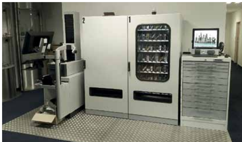
KROMI Tool Management: intelligente Lagersysteme wie der KROMI Tool Server KTS, das KROMI Tool Center KTC und das KROMI Kanban-System stellen quasi nur die Hardware im Tool Management Konzept dar. (Bild: KROMI)
