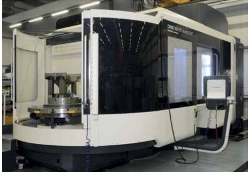
Mit dem neuen Dreh-/Fräszentrum DMC 160FD duoBlock von DMG Mori mit Drehtisch und X-/Y-Verfahrenswegen bis zu 160 cm erweitert die CDL-Präzisionstechnik die Kapazität zur Komplettbearbeitung von Großteilen. (Bild: KROMI)
